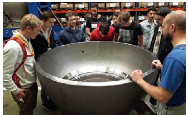
Geschmiedete und spanend bearbeitete Kugelhahnhälfte
