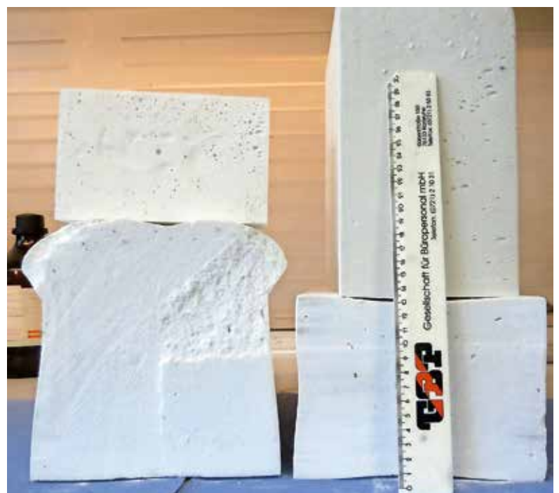
Einige Steinschäume, hergestellt für Dämmzwecke. Zu ihrer Herstellung werden nur nachhaltig verfügbare Rohstoffe verwendet
