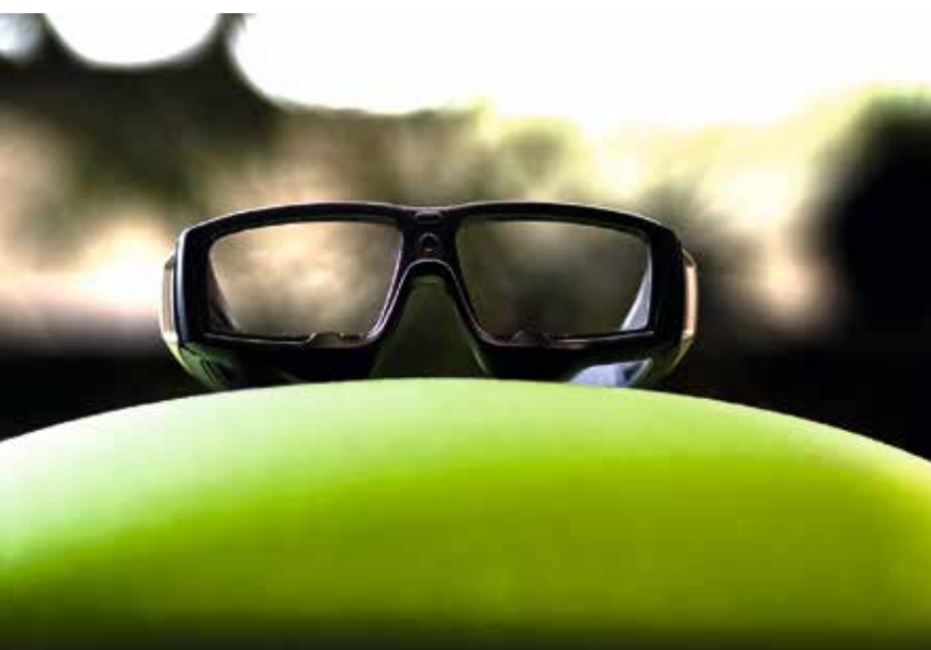
Bei den Eyetracking Glasses befindet sich im Brillensteg neben den zwei Hochleistungskameras eine HD-fähige Szenenkamera
