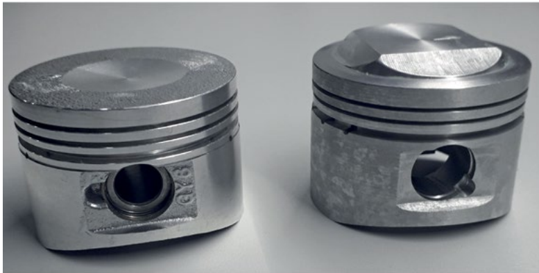
Abb. 3: Serienkolben (links), Sonderkolben (rechts)
