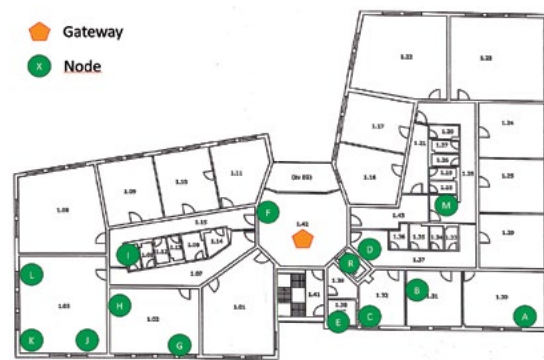
Abb. 3: Aufbau der Reichweitenmessungen und Lageplan
