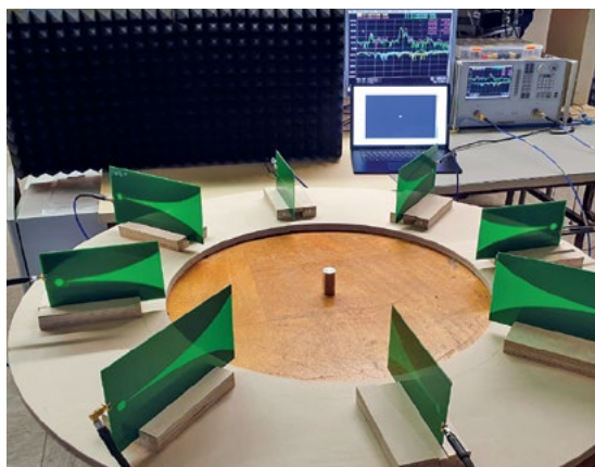
Abb. 1: Messaufbau mit acht Vivaldi-Antennen
