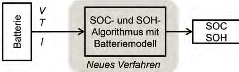
**Abb. 3:** Prinzip der modellbasierten Zustandsbestimmung. Ladezustand (SOC) und, wenn gewünscht, auch Gesundheitszustand (SOH) werden mit einem mathematischen Algorithmus berechnet, der als Eingangsgrößen gemessene Batteriespannung  $V$ , Stromstärke  $I$  und Temperatur  $T$  erhält.
