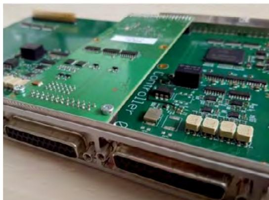
Abb. 3: Reglerhardware als Einsteckmodul mit FPGA, Compact PCI-Anbindung und Drehgebererfassung
