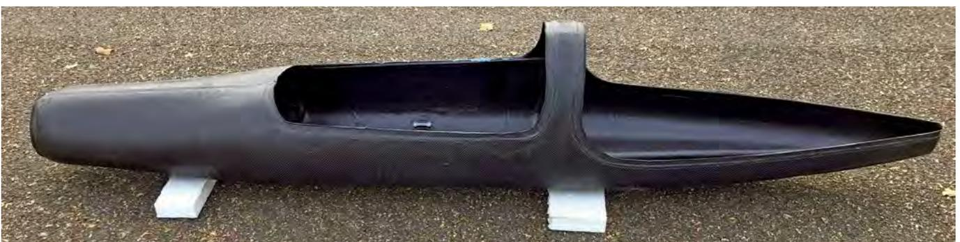
Zugänglichkeit der Fußbremsen für Wartungsarbeiten als auch zu einem einfachen und schnellen Wechsel der Nase im Falle eines Frontalcrashes.
