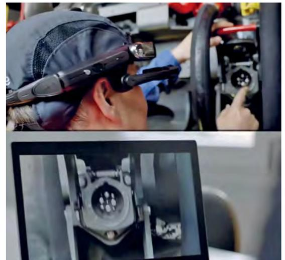
Abb. 2: Dank Datenbrille auf die Schiene: Die auf der Datenbrille installierte Software ermöglicht das Teilen von Informationen durch Übermittlung von Daten in einer Videokonferenz-Umgebung.
