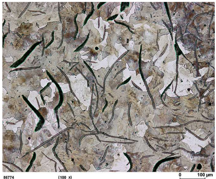
Abb. 1: Lichtmikroskopische Aufnahme der Mikrostruktur von Gusseisen mit lamellaren Graphitausscheidungen (dunkel)
