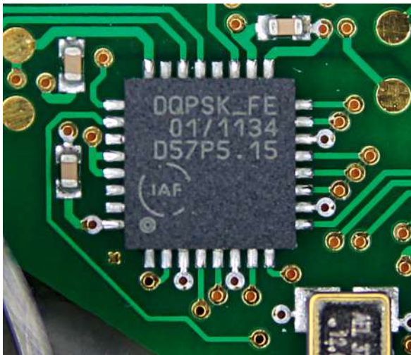
Abb. 2: Der an der Hochschule entwickelte LF-Telemetrie-ASIC, montiert auf der Elektronikplatine der Infusionspumpe
