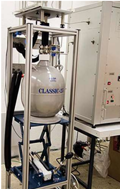
Abb. 1: Versuchsstand zur Messung von Wasserstoffsorption bei 77 K (Foto: Rubotherm)
