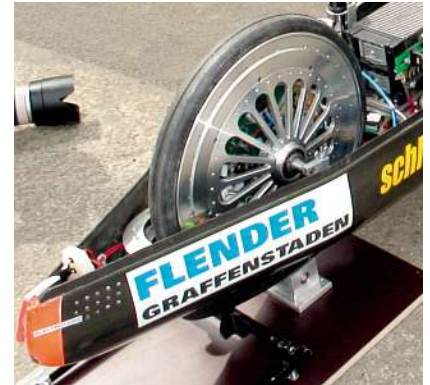
Abb. IV.8.2-2: Fertig gestellter Motor in eingebautem Zustand
