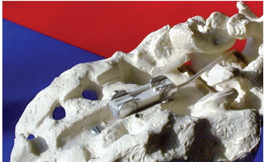
Abb. V.8-1: Prototyp des Implantats mit Stimulierungselektroden und thermoelektrischem Kühler
