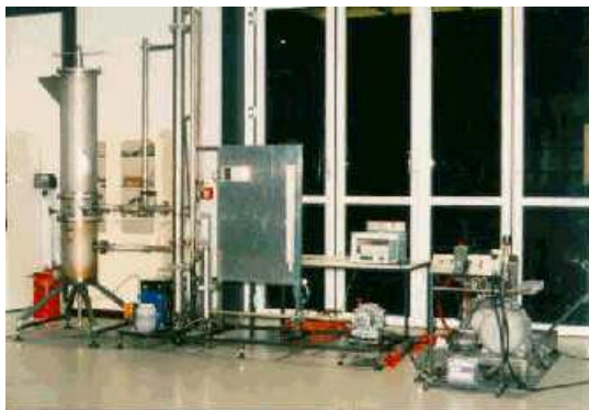
Abb. III.18-1: Holzvergaser mit Verbrennungsmotor und Generator im Technikum der FHO
